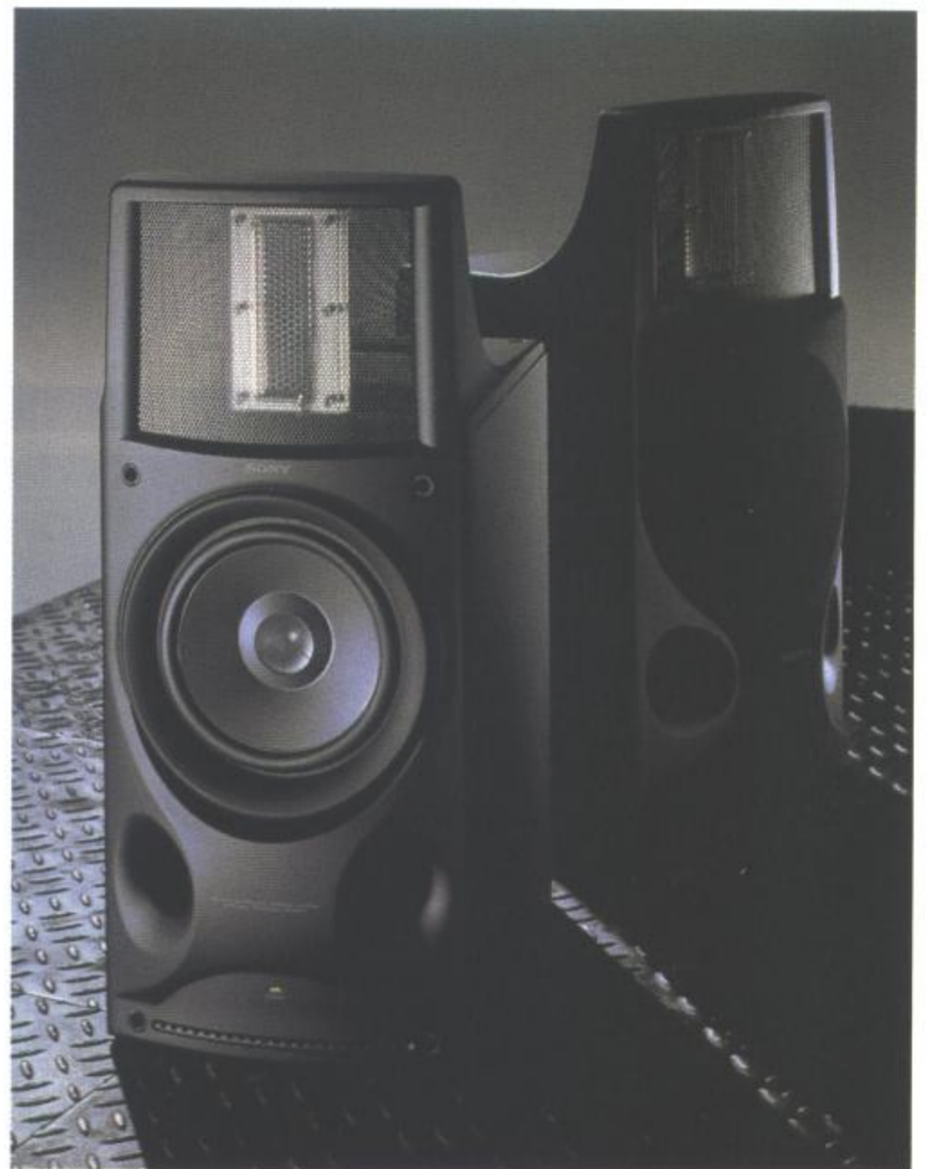
Hoge kwaliteit Motional Feedback luidsprekers met electrostatische tweeters zorgen voor een uitstekende geluidswaerweergave.
